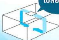
กระจายลม 2 ทิศทาง ลดอุณหภูมิผนังห้อง
